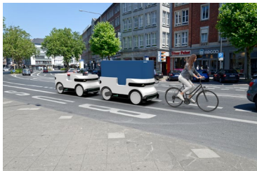
Abbildung 4: Autonomer Bot der einem Menschen folgt, könnte auch einem Lastenrad o.Ä. folgen. Quelle: Ducktrain
